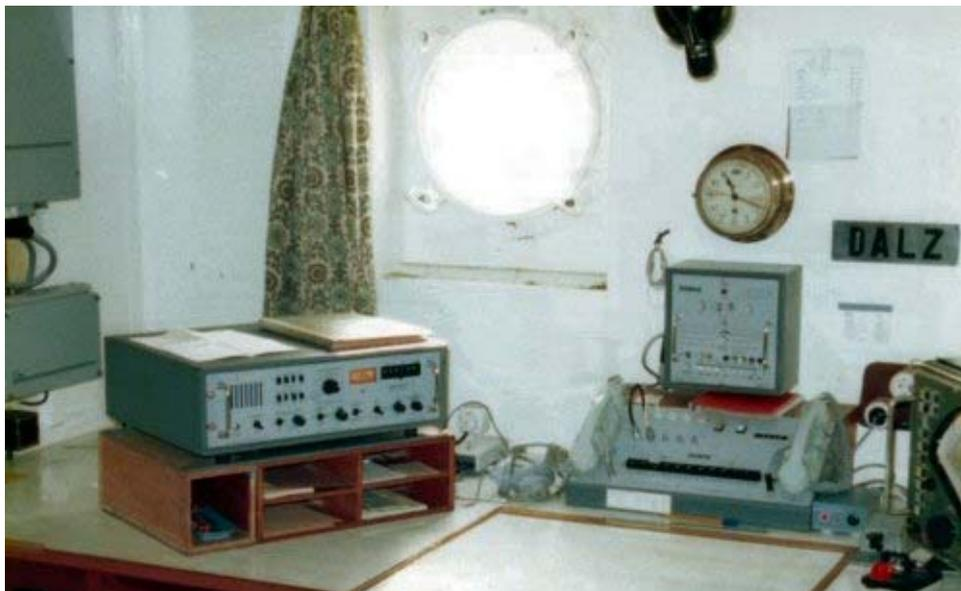
Rechts im Bild erkennt man gerade noch den [Allwellenempfänger Siemens E 566](#). Er erfasst in 12 Teilbereichen die Frequenzen 14 - 21 kHz und 85 - 30300 kHz in den Betriebsarten A1, A2 und A3. Links neben dem RX steht eine [Morsetaste der Firma Junker](#) auf dem Tisch.
